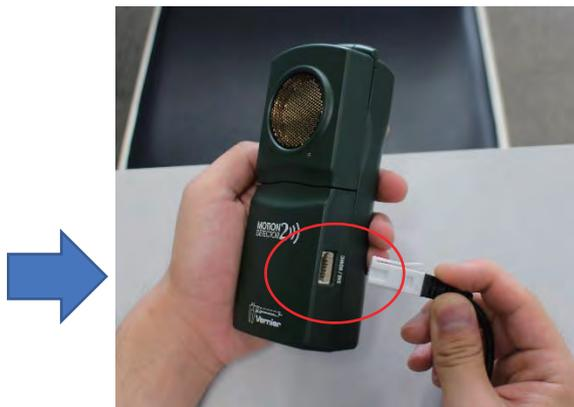
図 8 距離センサー側の差込口
