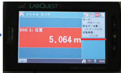
図8 収集時間が 10.0 秒に変更されている
